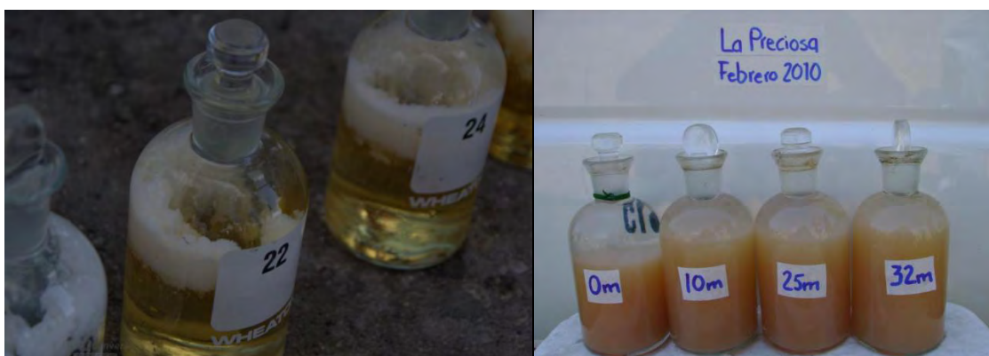
Fotos. 20 y 21. Determinación de oxígeno disuelto por el método de Winkler.
