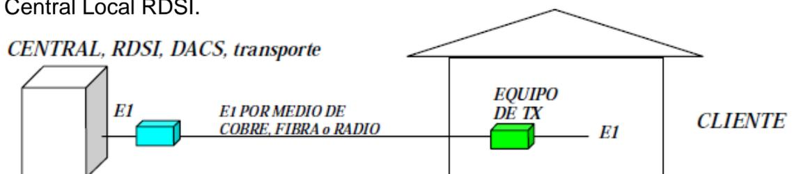
Fig. 1.18 Servicios E1's son interfaces que permiten transportar Voz, Datos, Audio y Video hacia los diferentes equipos para su proceso a una velocidad de 2048 Kbps.
