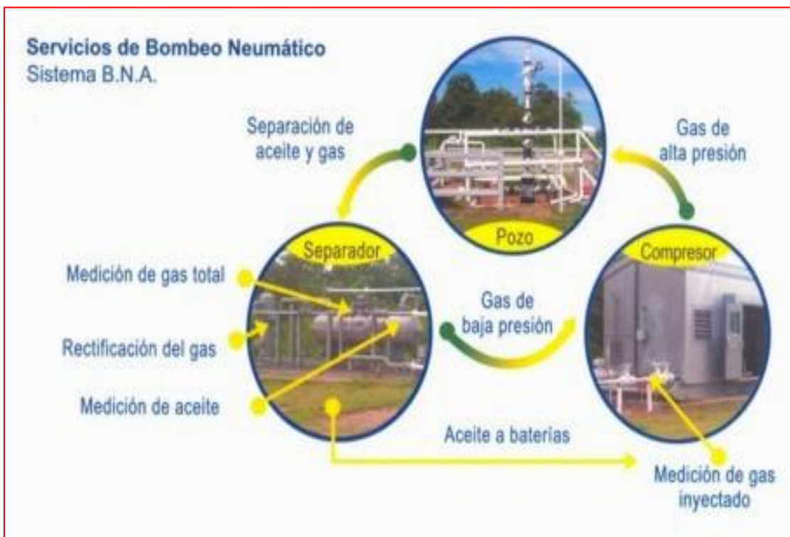
Fig. 1.25.- Principio de operación del BNA. Fuente: ENX
