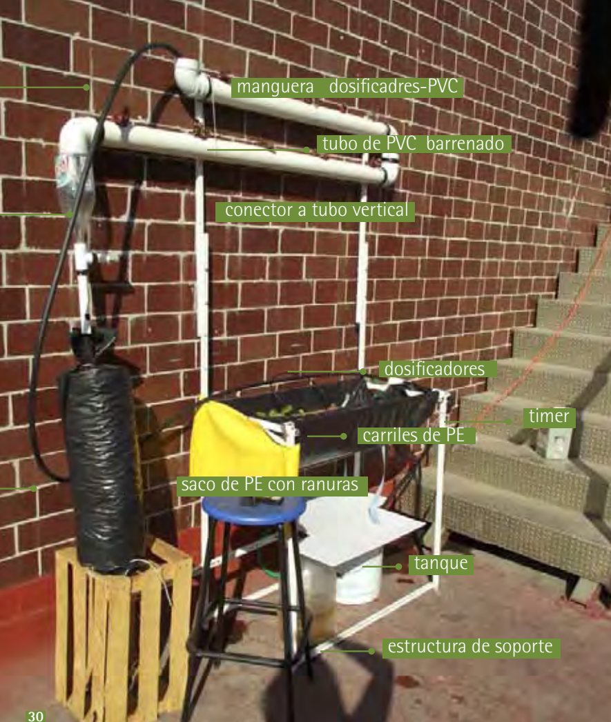
Fig. 30 Circuito de riego. Foto: Andrea Ortega
