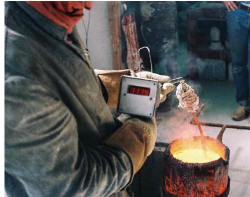
Figura F.5.- Medición de temperatura de fusión de un metal.
