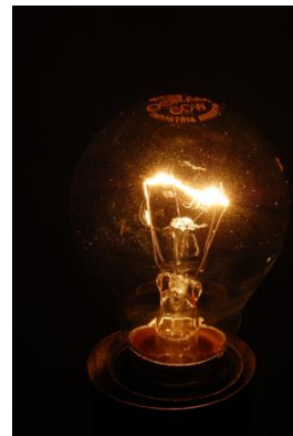
Lámpara incandescente con la tensión al final de la línea
