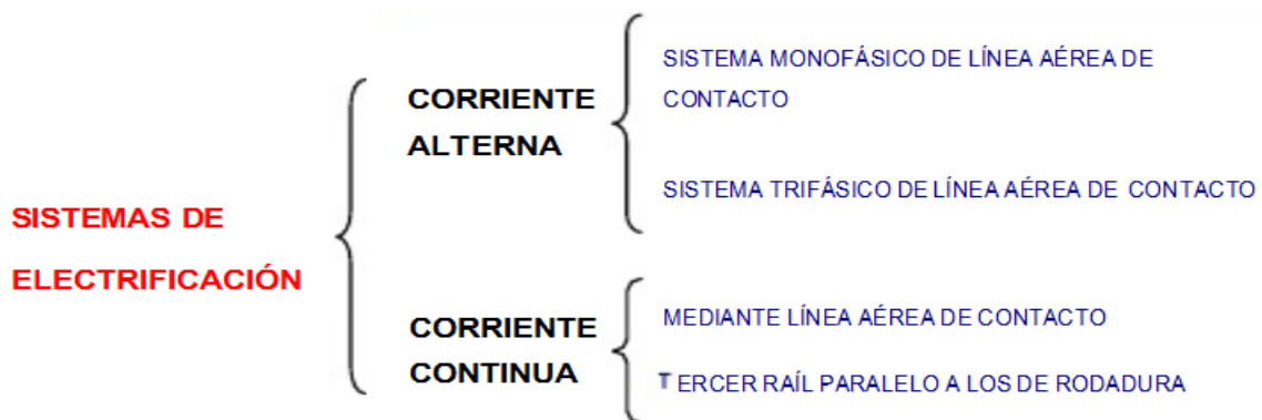
Cuadro 2.2. Sinóptico de la clasificación para sistemas de electrificación de trenes.
