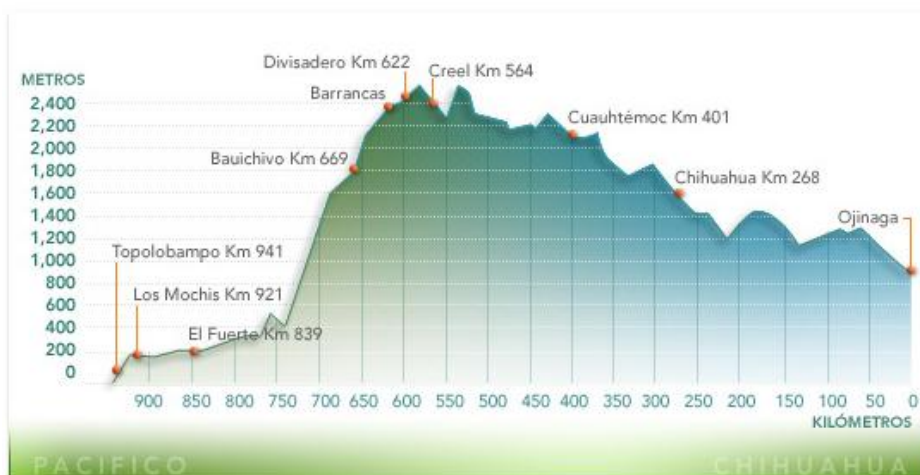
Figura 3.20. Grafica de distancia recorrida en kilómetros y altitud en metros de la ruta del ferrocarril Chihuahua – Pacífico.
