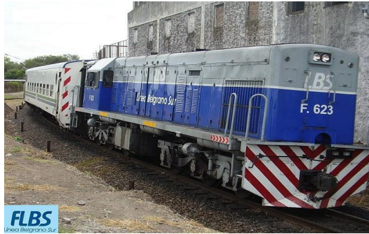
Figura 2.35. Locomotora diésel-eléctrica GE U12 utilizada para servicio de pasajeros.
