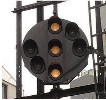
Figura 2.55. Señal mediante posición de luces.
