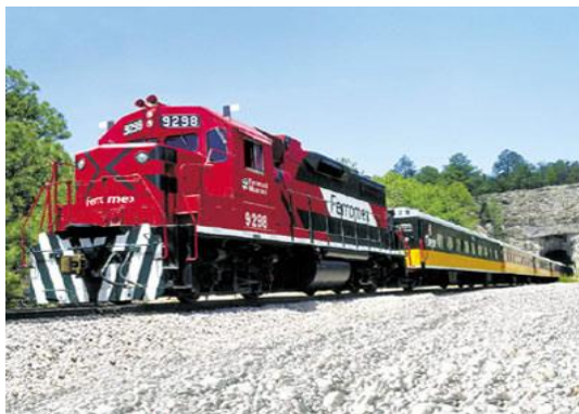
Figura 3.21. Unidades EMD, del modelo GP-40-2 utilizadas en el servicio del ferrocarril Chihuahua - Pacifico.
