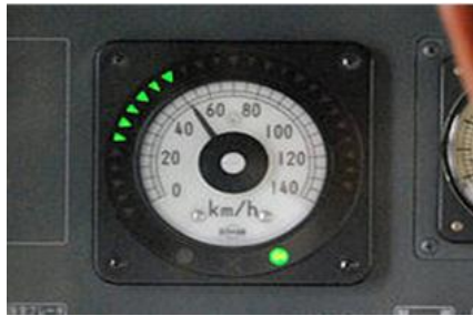
Figura 2.52. Indicador de velocidad con un sistema de señalización en cabina.
