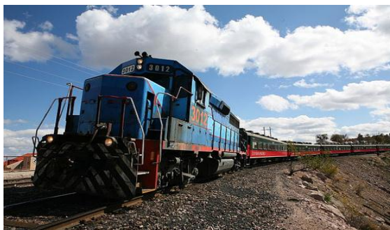
Figura 3.22. Unidades EMD, del modelo GP-40-2 utilizadas en el servicio del ferrocarril Chihuahua - Pacifico.
