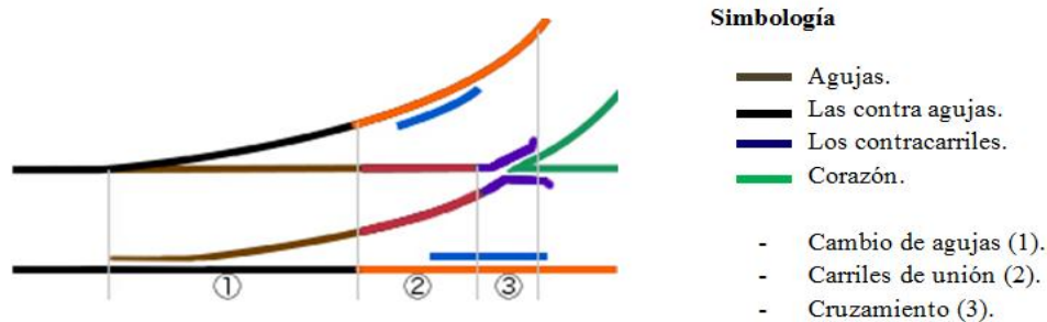
Figura 2.32. Componentes principales de un desvío.
