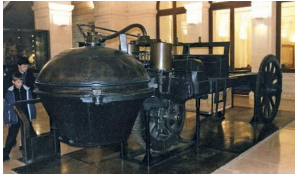
Figura 1.5. “Fardier” de Nicolás Cugnot fue uno de los primeros intentos de combinar la máquina de vapor y la rueda.
