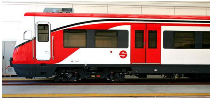
Figura 3.12. Carro motriz con cabina de conducción (clasificación “M”).
