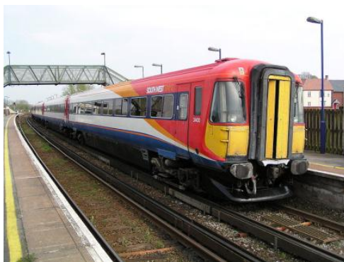
Figura 2.58. Tren de la serie 442 británica siendo alimentado por tercer riel.
