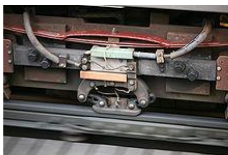
Figura 2.59. Frotador para alimentación por tercer riel.
