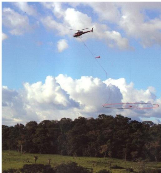
Fig. 39. Levantamiento aéreo TEM.
