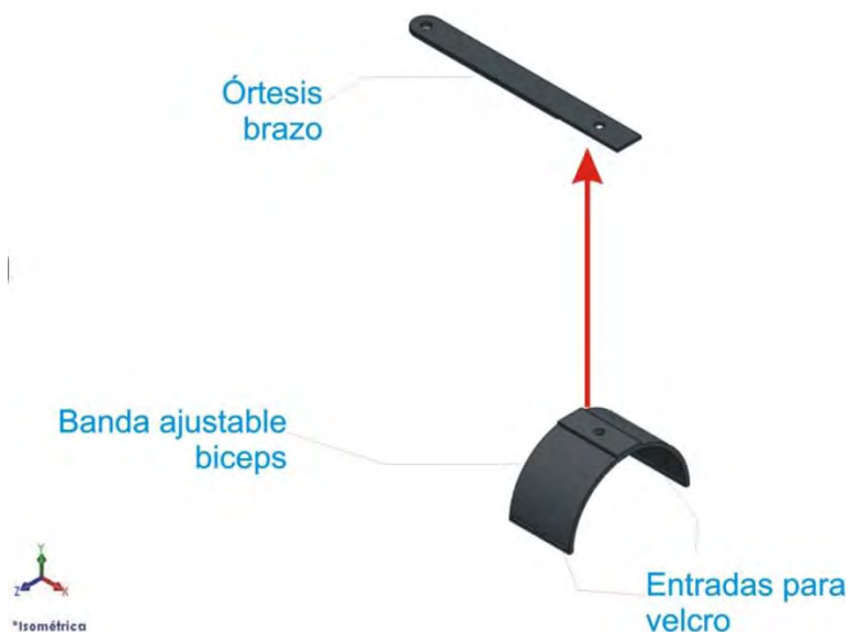
Ilustración 24 explosión de piezas banda ajustable bíceps respecto a órtesis brazo
