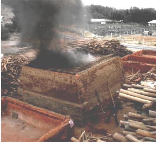
Foto de un horno piramidal para ladrillos en función, cerca de la ladrillera de "La Compañía". Jorge A. P. Escobar
