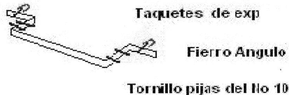
Figura 3.5.1.1 Soportería tipo portería para ductos mayores a 30"
