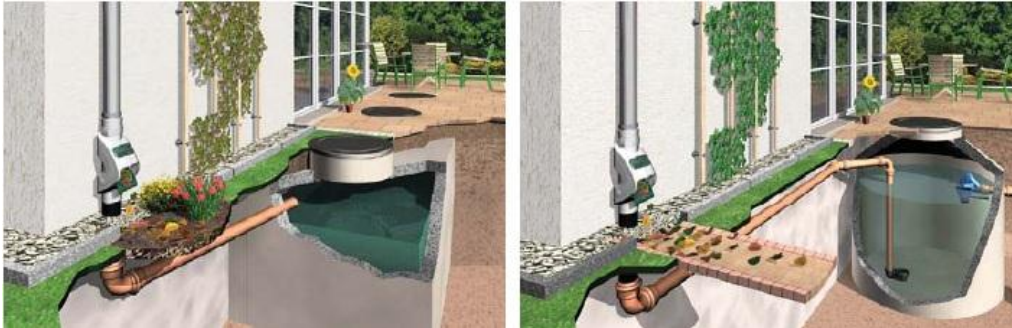
Fig. 40 Posibles instalaciones del Rainus M.R.
