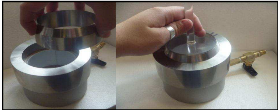
Figura A.8 Forma de colocar el anillo metálico y la muestra de suelo en el cuerpo de la celda.
