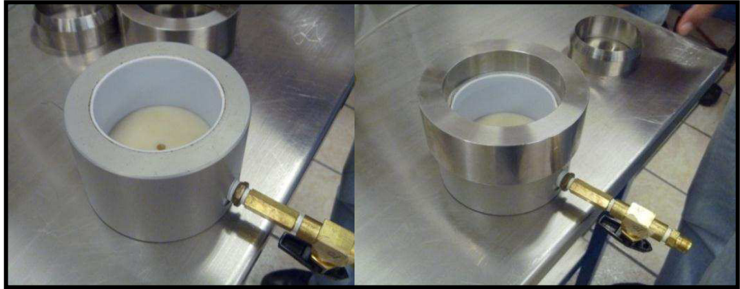
Figura A.7 Proceso de ensamblaje de piezas de la Celda Rowe durante la etapa de montaje.
