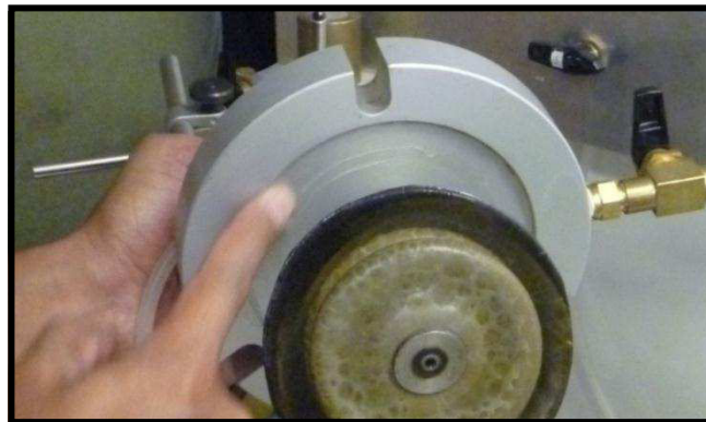
Figura A.10 Engrasado de la parte inferior de la tapa de la celda, para sellado de diafragma.
