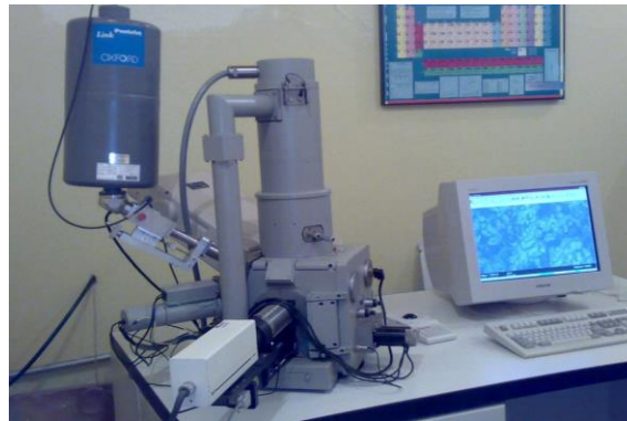
Figura 2.13 MEB del Instituto de Investigaciones en Materiales, UNAM.
