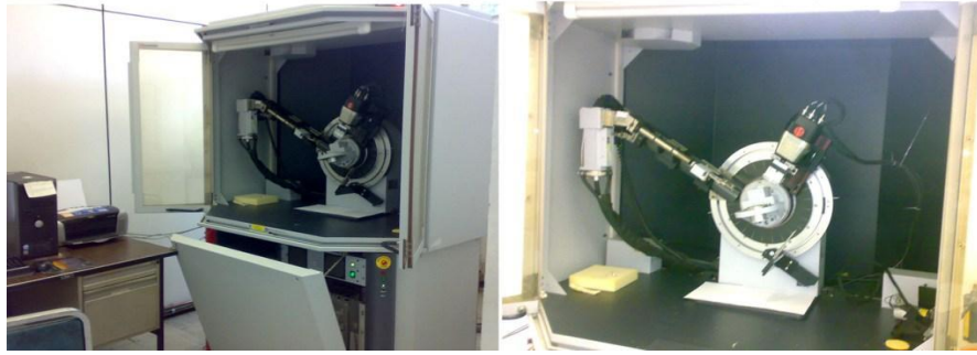
Figura 2.7 Difractómetro de polvos del Instituto de Investigaciones en Materiales, UNAM.
