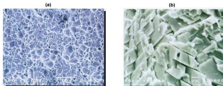
Figura 1.13 (a) Área pelada de la aleación Sn-Ag-Cu, (b) Área pelada de la aleación Sn-58%wt.Bi. [23]
