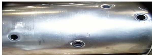
Figura 4.27 – A la izquierda, diseño anticipado de un estrangulador de fondo dañado por erosión en una prueba de vida acelerada. A la derecha, diseño mejorado sujeto a la misma prueba de erosión 10 .
