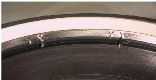
Figura 4.28 – Asiento de estrangulador por erosión (izquierda) y diseño mejorado (derecha) después de una prueba de vida acelerada con un flujo de arena del 2 al 3% en un volumen a 70 kg/cm 2 aproximadamente 10 .
