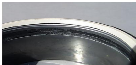
Figura 4.28 – Asiento de estrangulador por erosión (izquierda) y diseño mejorado (derecha) después de una prueba de vida acelerada con un flujo de arena del 2 al 3% en un volumen a 70 kg/cm 2 aproximadamente 10 .
