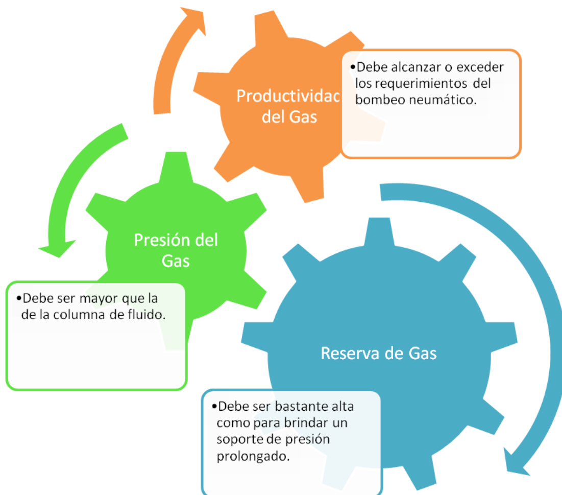
Figura 4.13 – Consideraciones básicas sobre el uso del casquete de gas para bombeo neumático de una formación contigua o productora de aceite.
