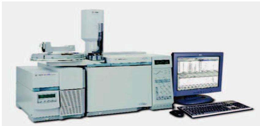
**Figura 4. Cromatógrafo de gases acoplado a espectrómetro de masas.** Se compone de inyector, gas acarreador, columna con horno a temperatura controlada y espectrómetro de masas de tipo cuadrúpolo con ionización por impacto electrónico (Imagen proporcionada por el Laboratorio de errores innatos del metabolismo y tamiz (LEIMyT) del Instituto Nacional de Pediatría (INP).
