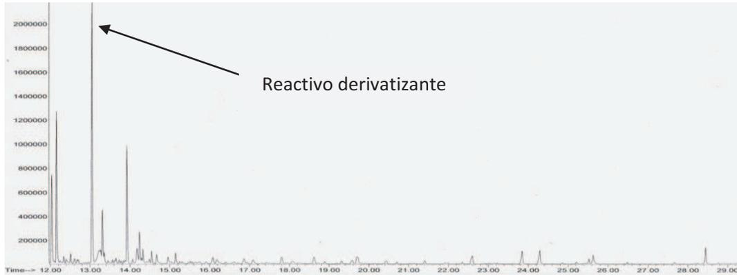
Figura 12. Cromatograma de agua extraída de PF. Únicamente se observó el reactivo derivatizante (BSFTA).
