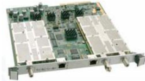
Fig. 2.20 Tarjeta de línea del hub.
