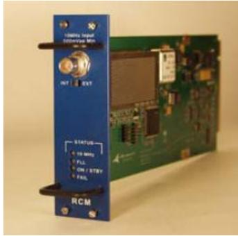
Fig. 2.21 Módulo de reloj de referencia
