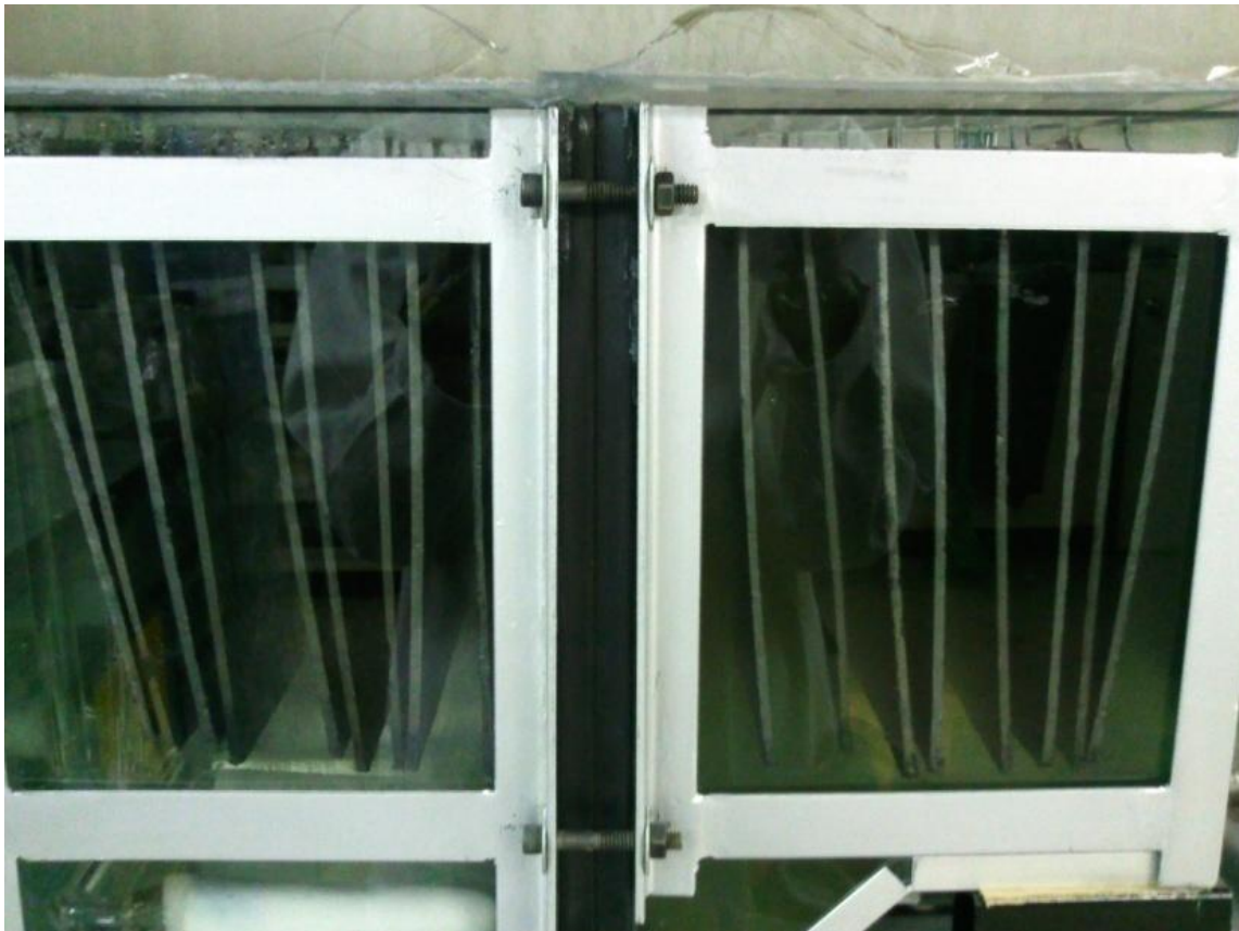
Figura 2.1. Vista frontal de la celda de combustible.
