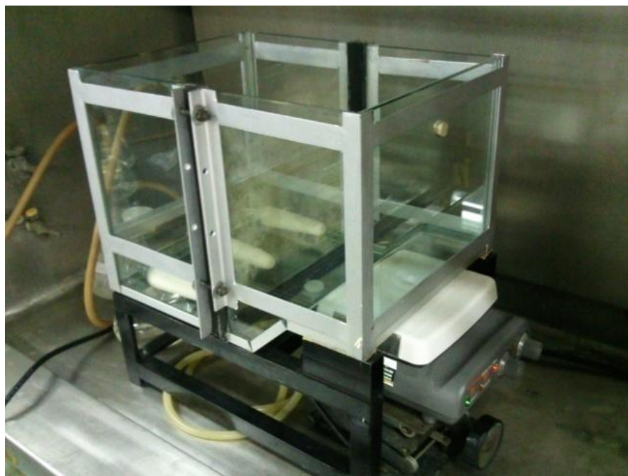
Figura 2.4. Sistema de agitación en la cámara anódica
