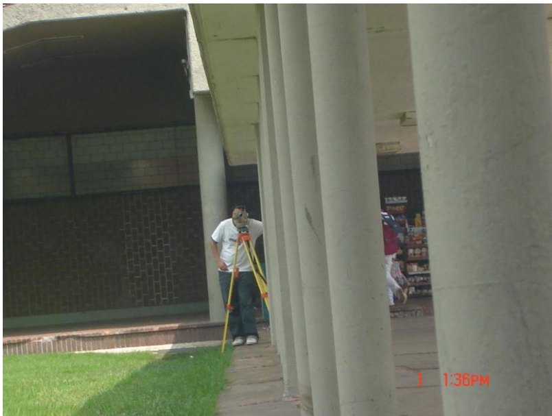
Alineación de la línea tomando como base la colimación entre el punto "A" y el punto "10" ( d=40m ).
