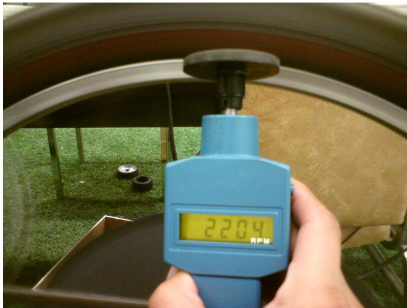
FIGURA 9.3 Tacómetro digital en la llanta trasera de la bicicleta
