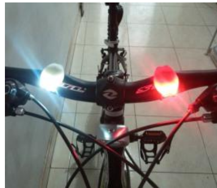
FIGURA 5.13 Luces led de baterías
