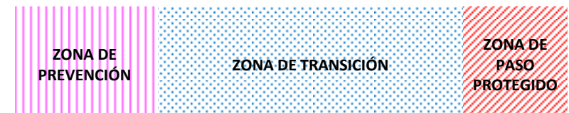
FIG. 151 Esquema de escala de señalización en zona escolar.
