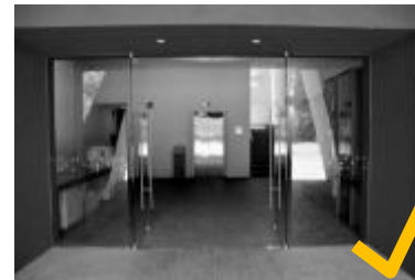
FIG. 21 El acceso está remetido. Evita la salida directa al paso peatonal.
