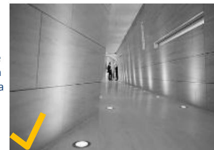
FIG. 29 La colocación lineal de las luminarias en piso, ayudan visualmente a delimitar el área de circulación.
