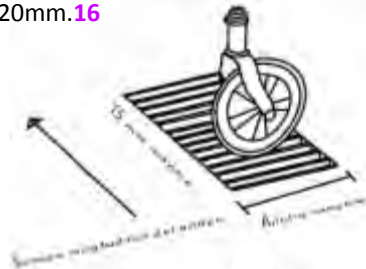
FIG. 182 Los huecos longitudinales deben ser máximo de 15mm.
