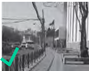
FIG. 123 Paso con adecuada franja de circulación.
