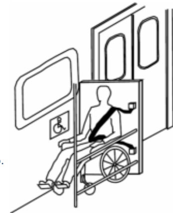
FIG. 143 Se indica con SIA, cuenta con cinturón de seguridad y barras de apoyo.
