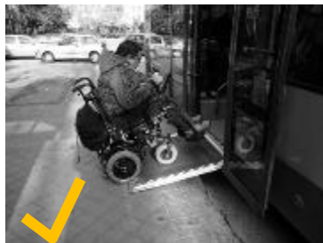
FIG. 44 Autobús con rampa plegable facilita el acceso del usuario.
