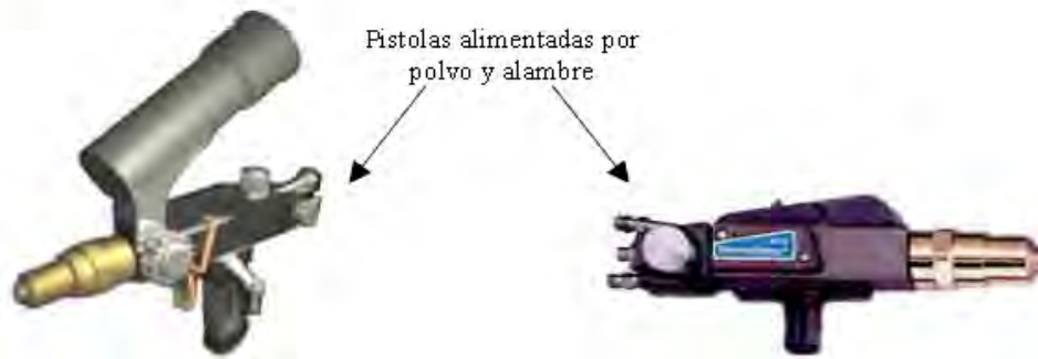
Figura 2.24 Armado del equipo de proyección térmica por alambre [10].
