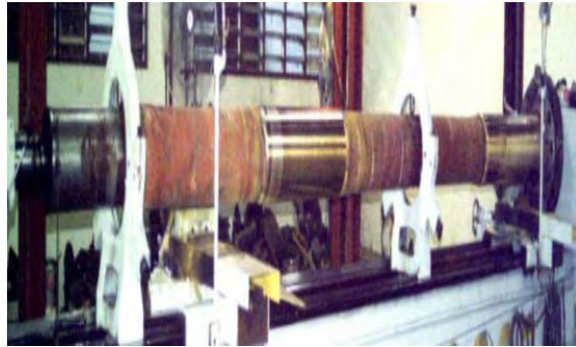
Figura 2.19 Eje de la propela de un Barco. Se restauran las zonas en donde se montan los rodamientos [10].
