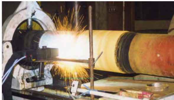
Figura 2.20 Se rocía una aleación de aluminio-bronce mediante equipo de arco eléctrico en la zona a restaurar [10]
