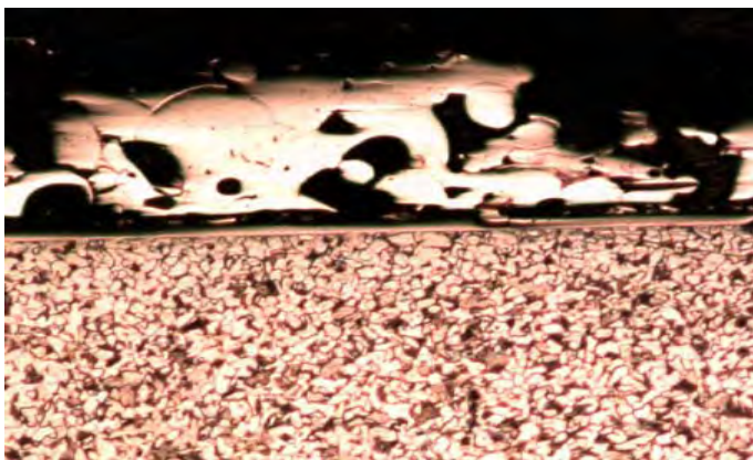
Figura 4.7 Aspecto del recubrimiento dúplex constituido a 50 X y 100 X (Microscopio Óptico)
