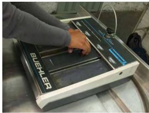
Figura 3.9 Frotación de la superficie del sustrato sobre las lijas.
