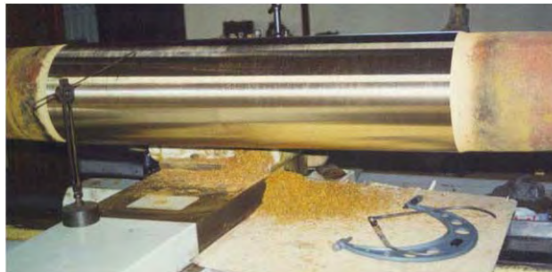
Figura 2.22 Recubrimiento maquinado. Eje listo para volver a prestar servicio [10].
