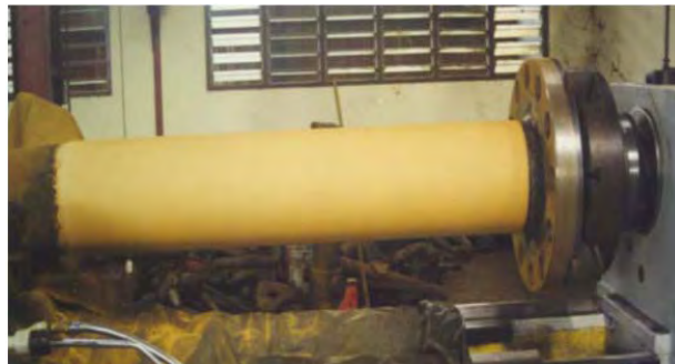
Figura 2.21 Recubrimiento de aluminio-bronce obtenido después de rociar [10].
