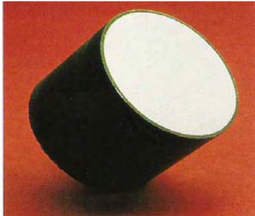
Figura 2.18 recubrimiento de aluminio sobre un varistor de metal-óxido obtenido por arco eléctrico [10].
