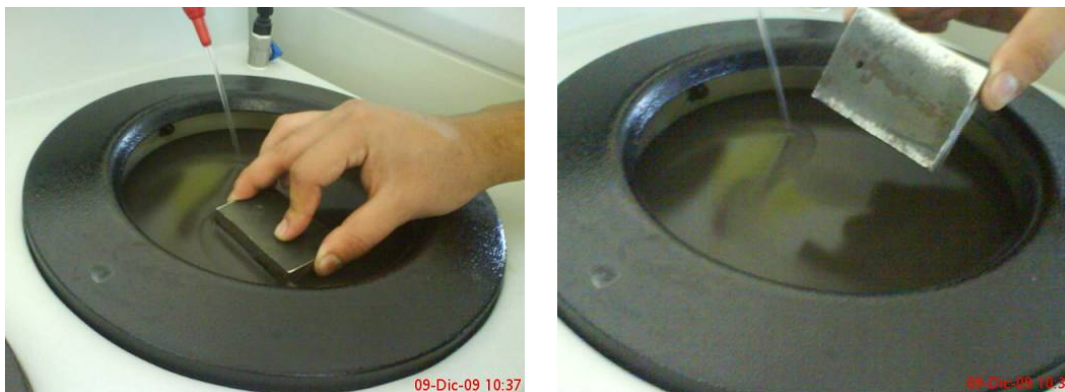
Figura 3.2 Lijado del sustrato para obtener una rugosidad que nos permita la adherencia del níquelado químico.
