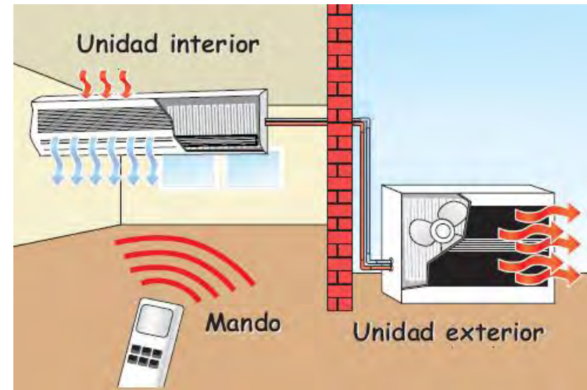
Sistema de mini splits (inyección de aire)
