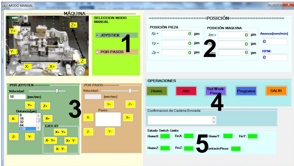
Figura 4.20 Pantalla para operar en modo manual.
