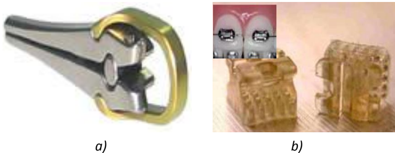
Figura 5.28 (a) Micropinza de cerámica menor de 3 mm para aneurisma, con tolerancia de 20 \mu m. (b) Micromolde para brackets dentales de 0.1 a 0.2 mm.
