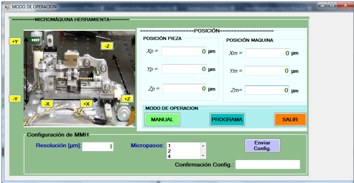
Figura 4.19 Pantalla de inicio para elegir el modo de operación.
