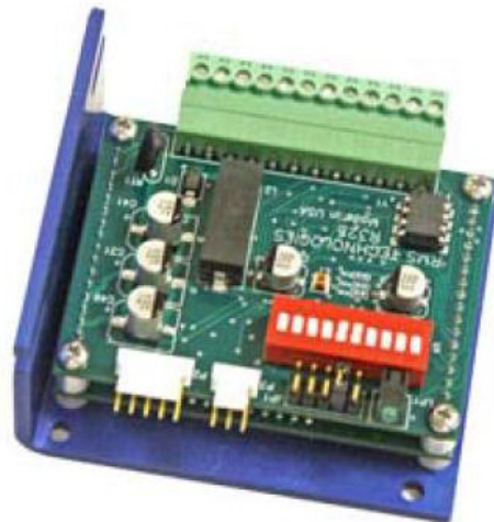
Figura 4.7 Driver controlador R-325.
