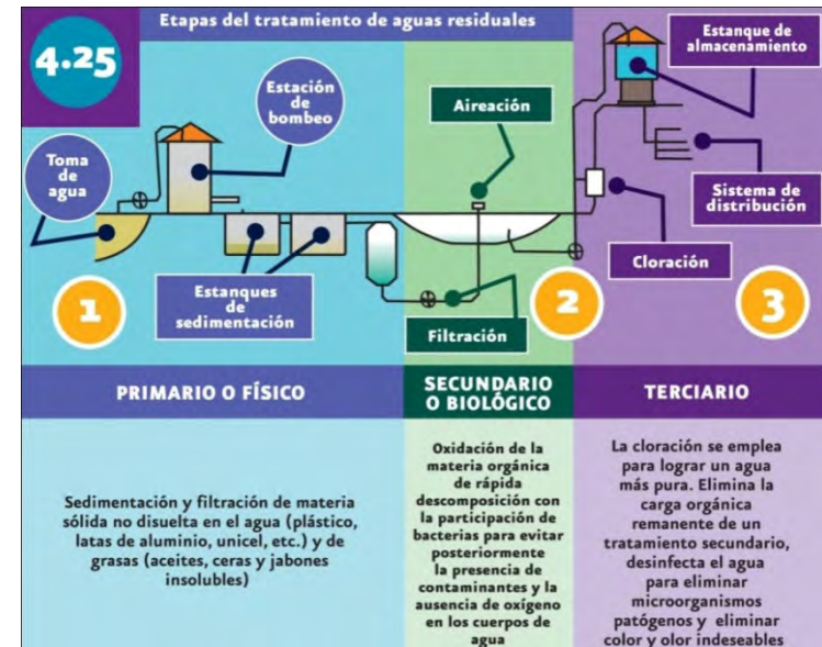
Figura 2.3.5.1 Tratamiento de aguas residuales
