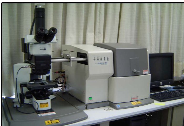
Figura 12. Espectrofotómetro Raman Dispersivo NicoletAlmega XR.
