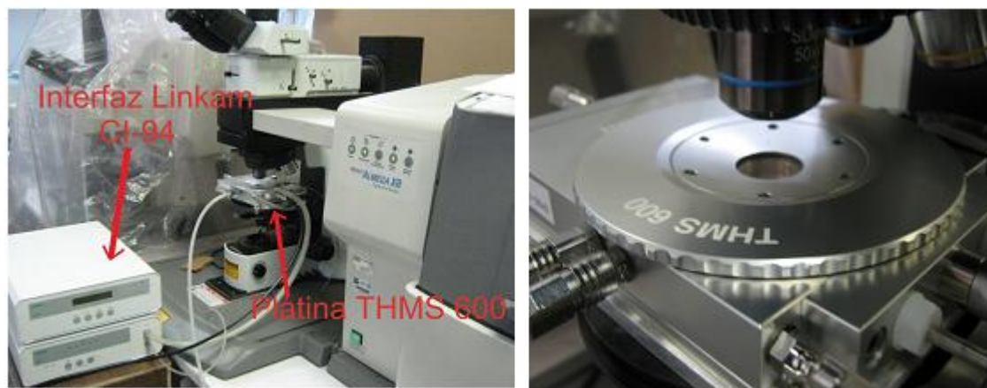
Figura 15. Platina de temperatura montada en el microscopio del sistema Raman Almega XR.
