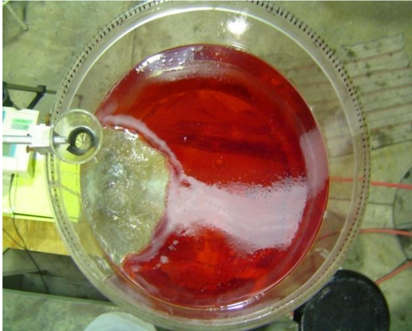
Figura 5. Experimento 4 ver (ver Tabla No.6) con una vista superior que muestra la apertura de escoria u "ojo".
