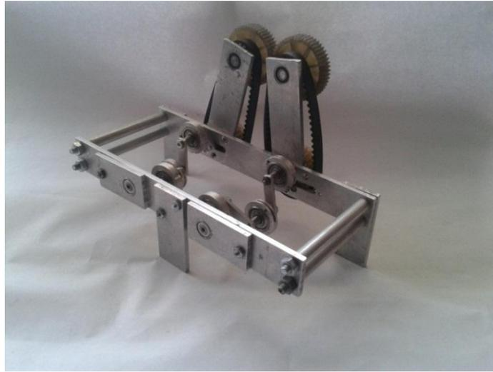
**Figura 3.1** Prototipo del motor con cigueñales sincronizados.
