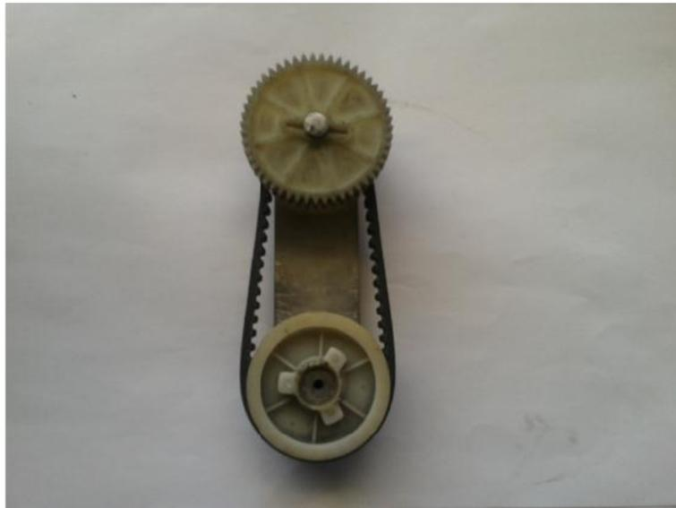
**Figura 3.6** Conjunto de poleas dentadas y engranes.
