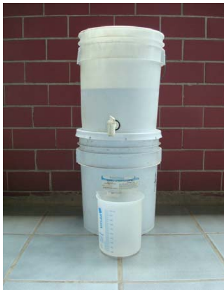
Figura 4. 1 Sistema de decantación
