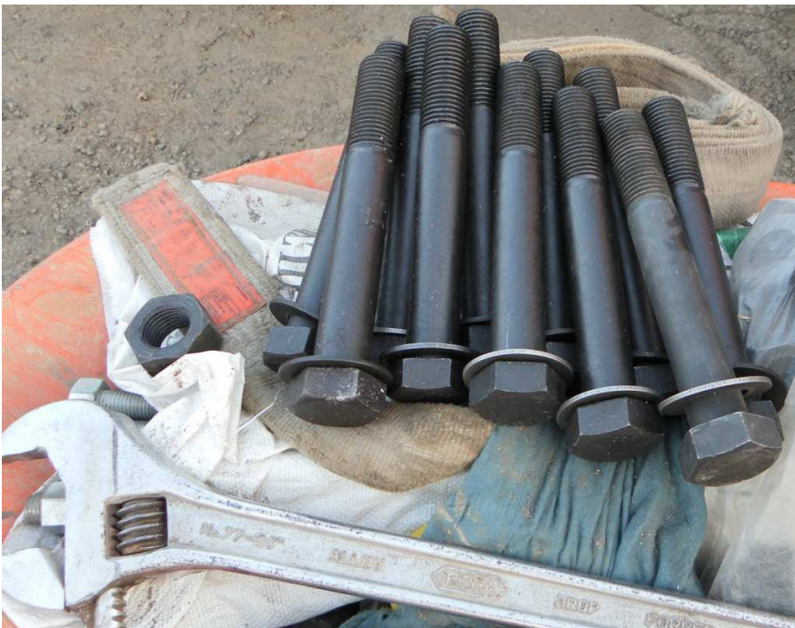
Fotografía 3. Materiales necesarios para la unión de tuberías PEAD.
