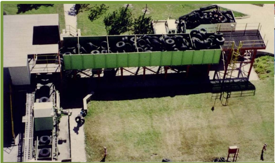
Fig. 5.1 Coprocesamiento de llantas en la industria del cemento (CANACEM, 2007)
