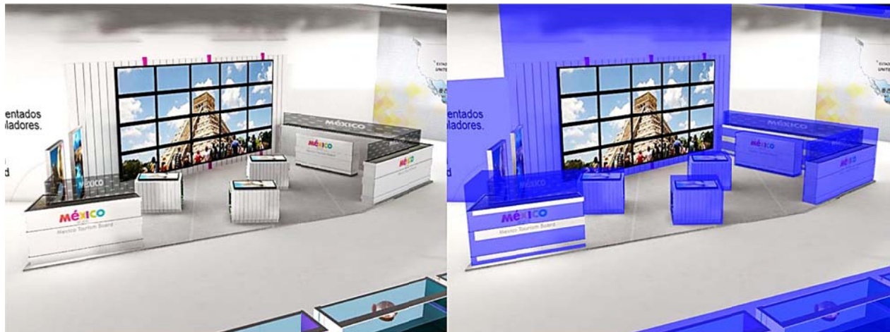
FIGURA 61. Los objetos de colisión se muestran en azul en la imagen derecha, son envolventes de los objetos que no debe atravesar la cámara. La escultura del “Cactus” (últimas dos imágenes) tiene 778 polígonos mientras que su objeto de colisión tiene 6.
