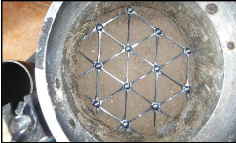
**Foto 13** Colocación de geomalla triaxial sobre espécimen de Limo-arenoso. (Suelo “B”).
