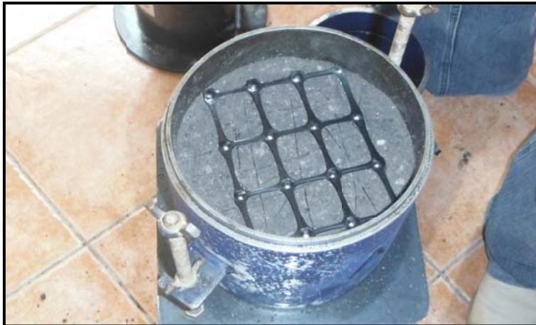
**Foto 14** Colocación de Geomalla biaxial sobre espécimen de Arcilla. (Suelo “A”).
