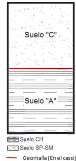
**Figura 4.24** Especímenes probados con dos materiales. (CH (saturado) / SP-SM).
