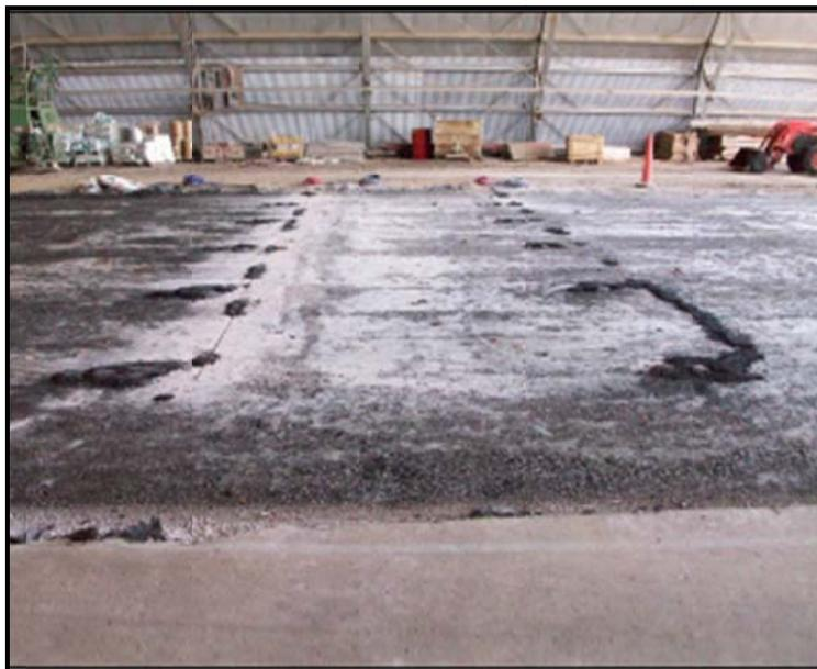
**Foto 2** Colocación de medidores de esfuerzo en carpeta asfáltica.
