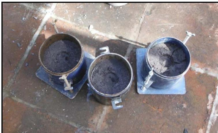
**Foto 15** Ensayo de especímenes de Arcilla de alta plasticidad. (Suelo "A").
