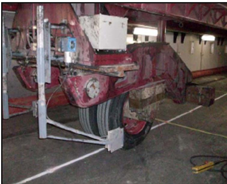
**Foto 6** Aplicación de carga con eje sencillo dual.
