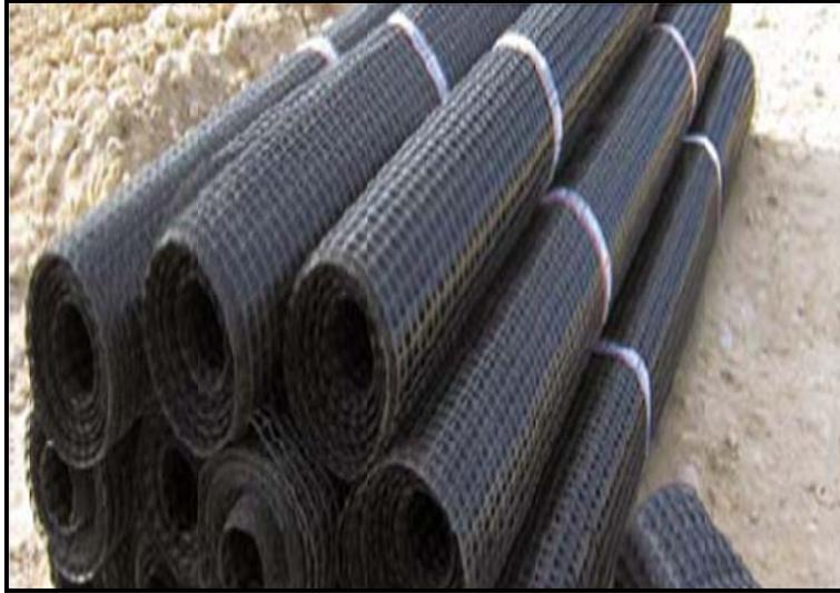
**Figura 5.2** Estiba de rollos de geomalla en obra.
