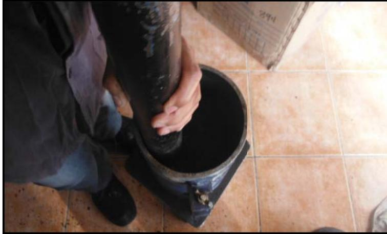
**Foto 17** Compactación de espécimen con dos materiales. (CH/SP-SM).
