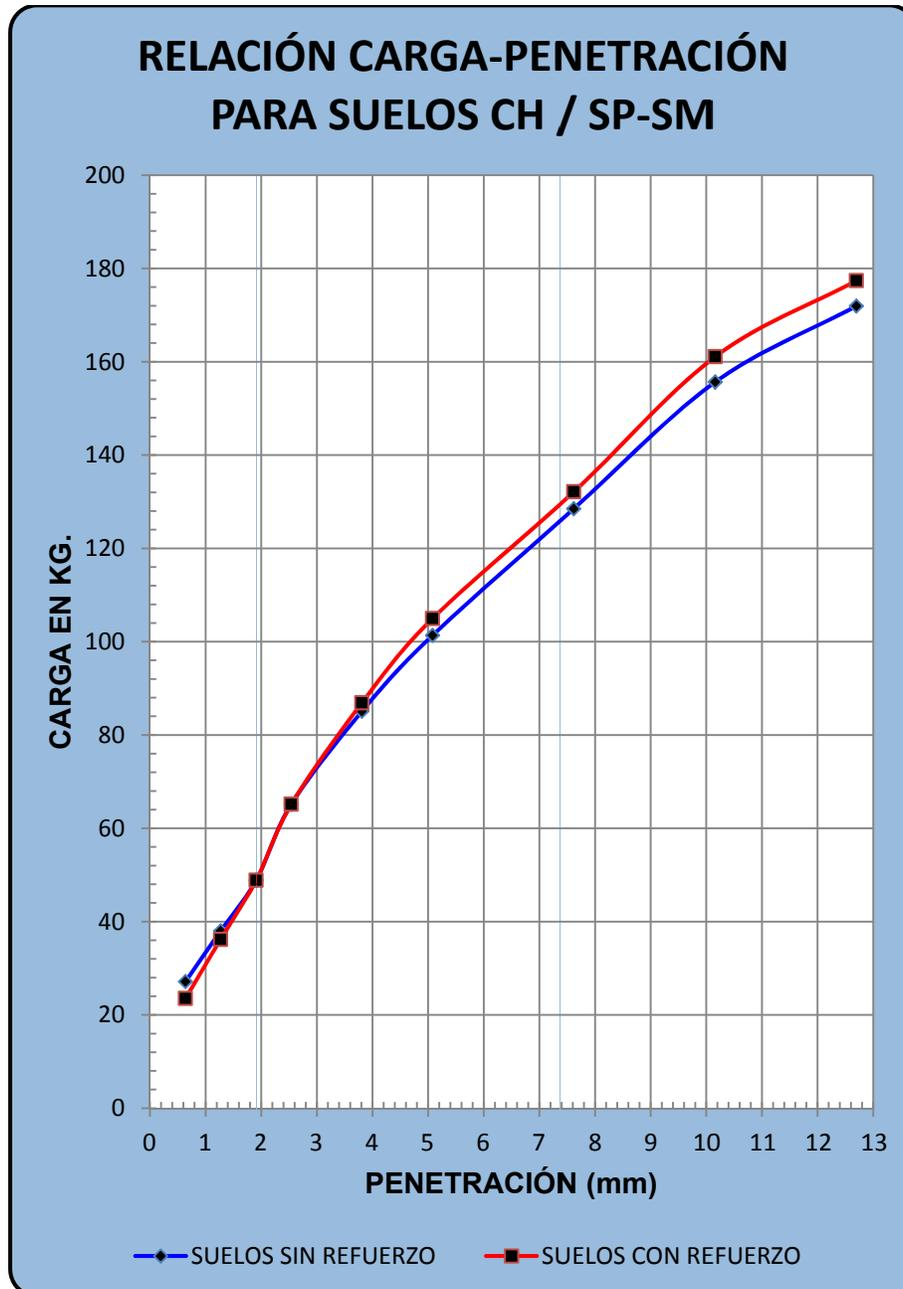
**Gráfica 2** Relación carga-penetración (especímenes de dos materiales) CH/SP-SM.
