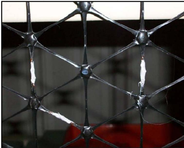
**Foto 3** Medidores instalados en la geomalla.
