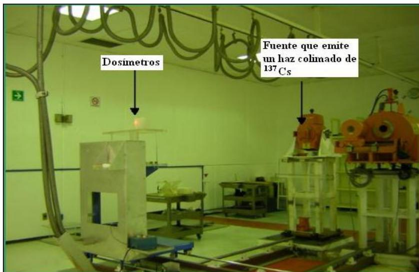
Figura 2.4 Arreglo experimental utilizado durante las medidas de calibración de los dosímetros TLD-100.
