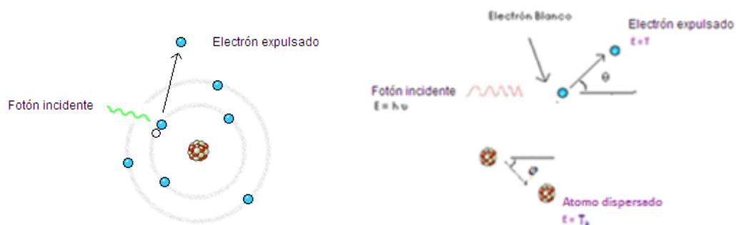
Figura 1.3 Esquema del efecto fotoeléctrico.
