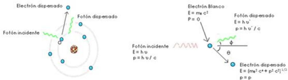
Figura 1.4 Esquema del efecto Compton.
