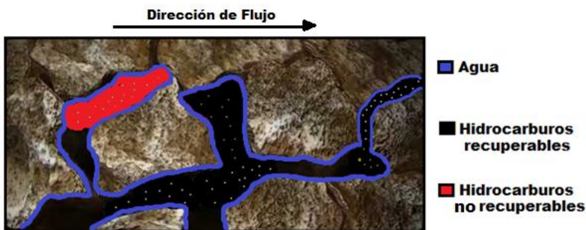
Figura 3.6 Capacidad de transporte de hidrocarburos recuperables para una cierta permeabilidad absoluta.
