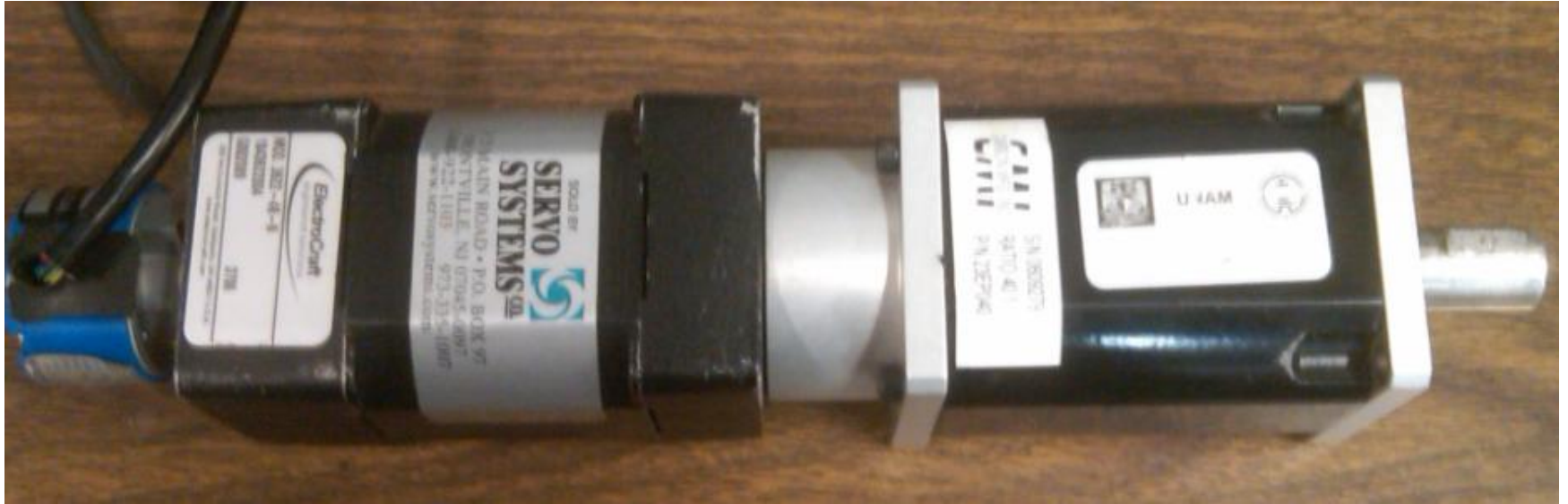
Acoplamiento del encoder (DA15-1000-5VLD), servomotor brushless (serie E-3622) y cabeza reductora (23EP040).
