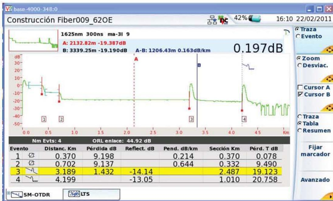
Figura 3.16 Resultado de la Prueba OTDR JDSU
