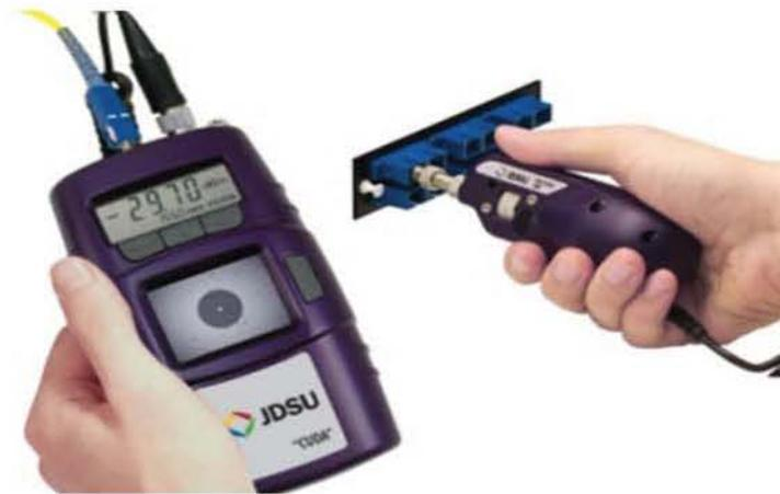
**Figura 2.13 Microscopio Digital FIT-S100-C con punta de Prueba y pantalla con medidor de potencia Integrado**
