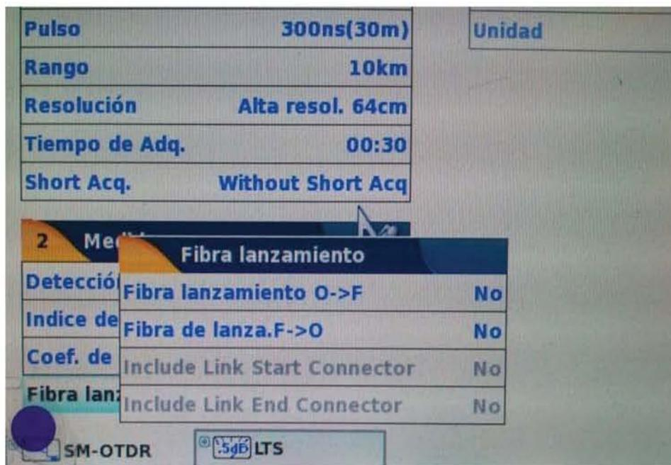
Pantalla 3.20 Menú Fibra de Lanzamiento del Equipo OTDR-JDSU.
