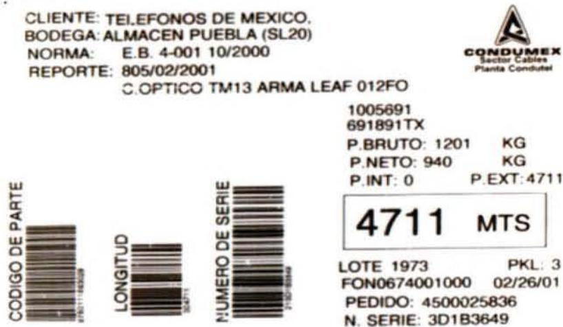
Figura 3.17 Tarjeta de identificación de carrete de Fibra Óptica
