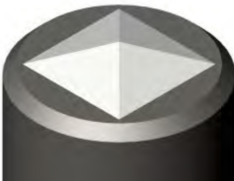
Figura 2.1a. Indentador piramidal Vickers
