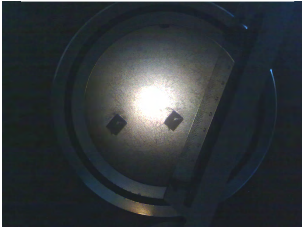
Figura 3.10. Medición de huellas dejadas por el indentador
