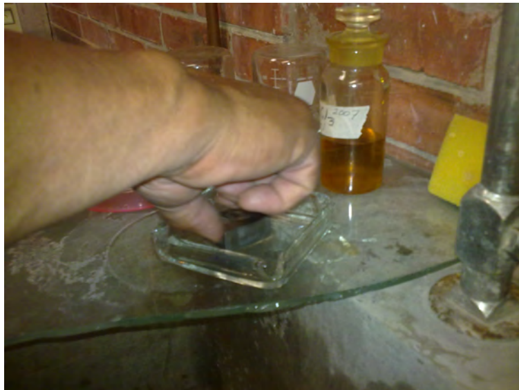
Figura 3.6. Ataque químico con \text{FeCl}_3
