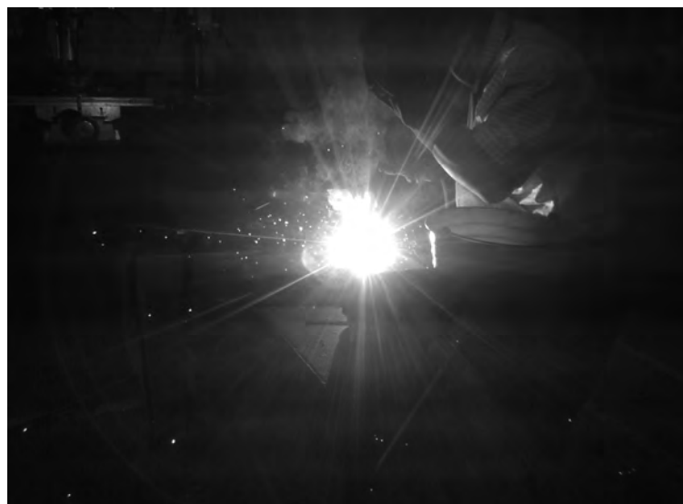
Figura 3.2. Realización del cordón de soldadura
