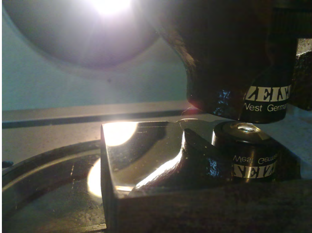
Figura 3.9. Toma de durezas
