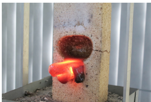
Fig. 3.22 Fotografía de un ladrillo mostrando la forma ovalada del material fundido debido al backlash.
