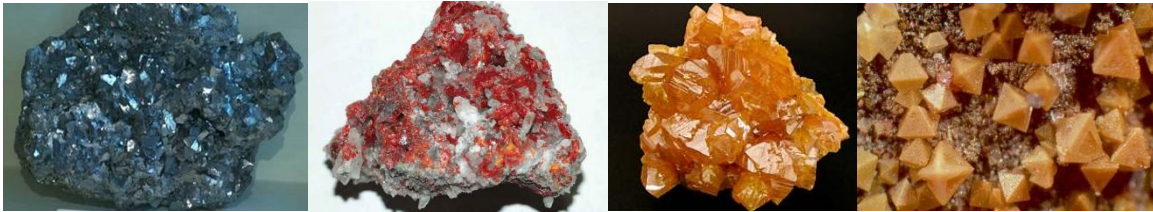
Figura 2. Minerales donde se encuentra asociado el arsénico, como ejemplo, se muestran en las figuras de arriba los minerales más representativos, de izquierda a derecha, se observa la arsenopirita, realgar, orpimente, arsenolita, respectivamente.
