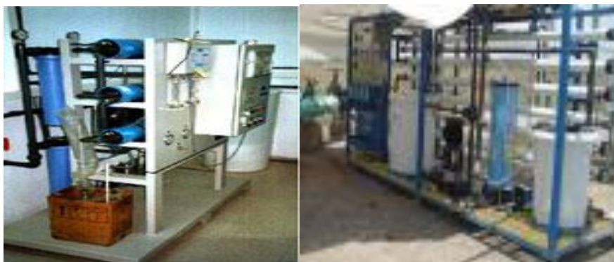
Figura 15. Instalaciones básicas de plantas de ósmosis inversa instaladas en zonas rurales de la Comarca Lagunera.
