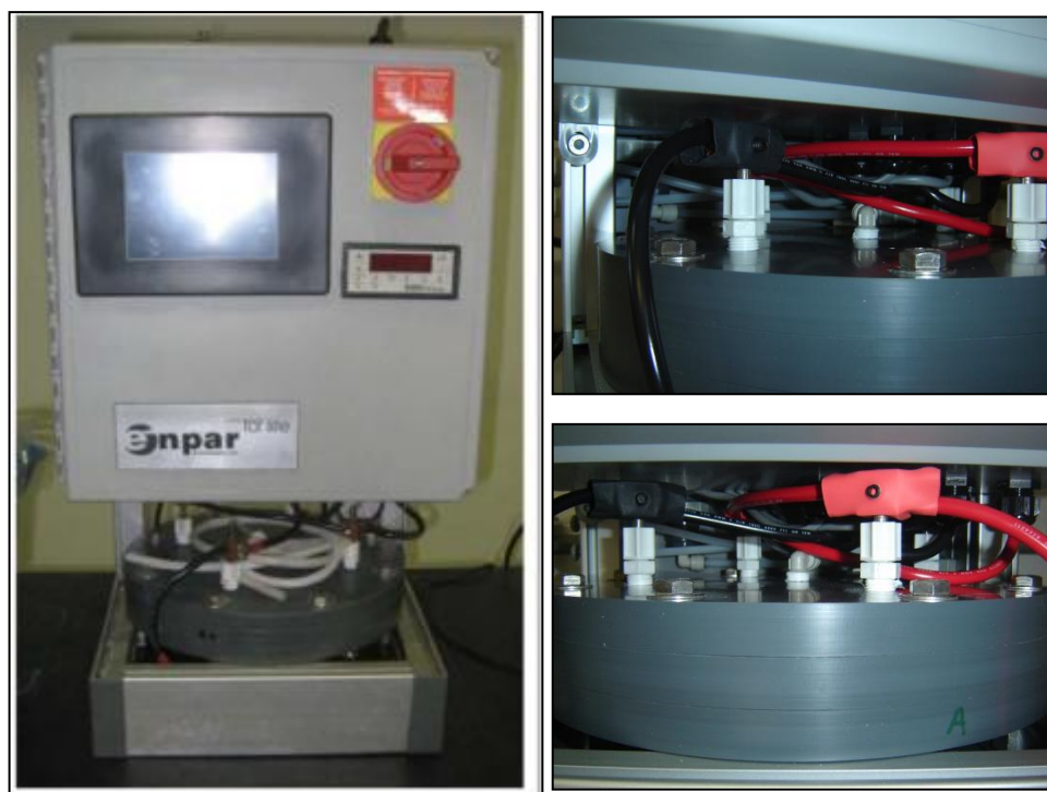
Figura 14. Deionizador capacitivo marca DesEL Modelo 400 y su celda electroquímica empleada para la remoción de los iones.
