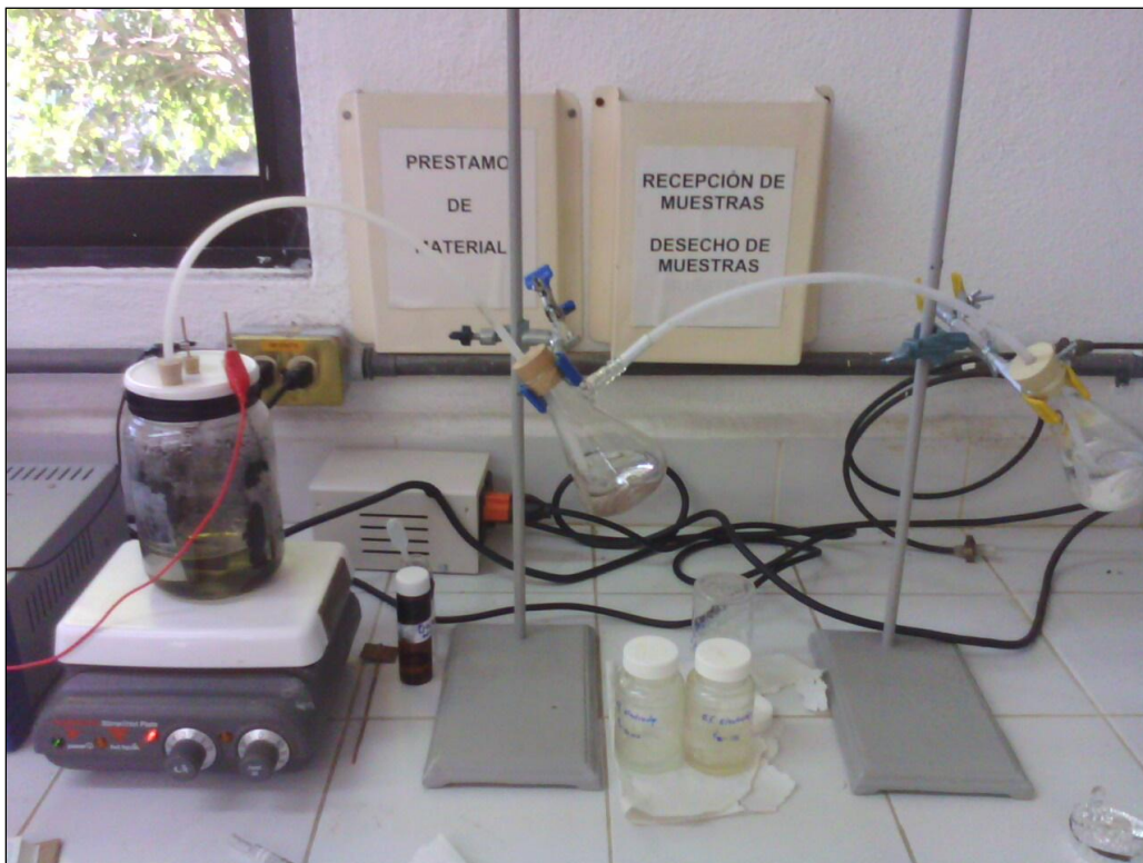
Figura 16. Montaje del equipo experimental del proceso de electrodeposición de As.
