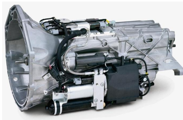
Fig. 16 Caja de velocidades típica de vehículos con tracción trasera
