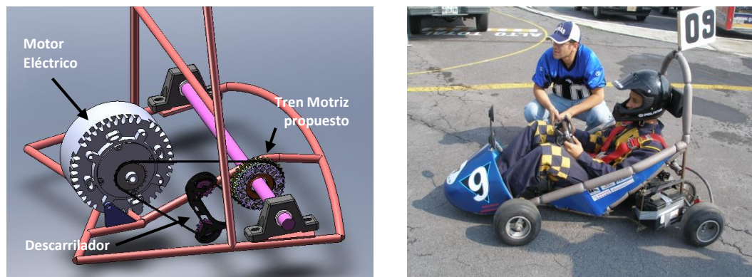
Fig. 20 y 21 Isométrico del tren motriz en CAD e imagen real del vehículo
