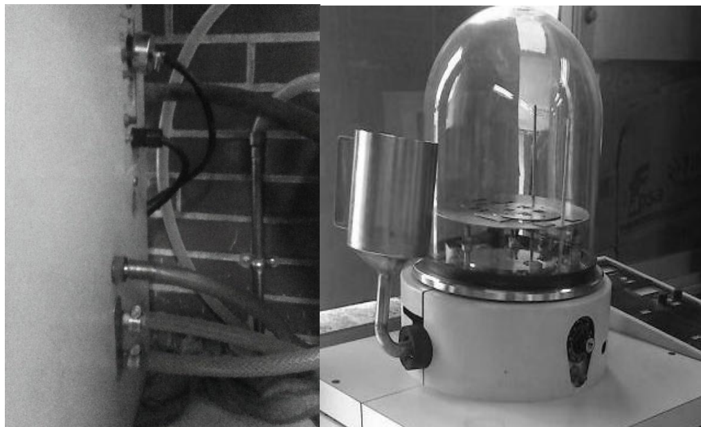
Figura 4.5. Imagen de las conexiones de enfriamiento y salida de gases, así como recipiente de nitrógeno líquido.
