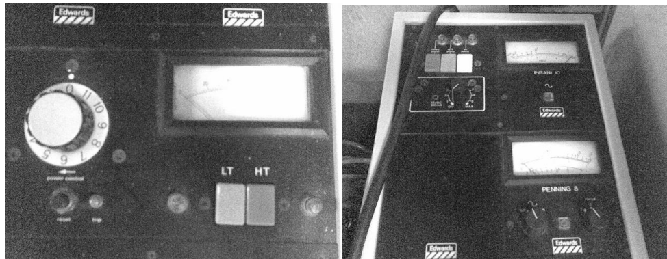
Figura 4.6 módulos de control de vacío, corriente y medidores de vacío.
