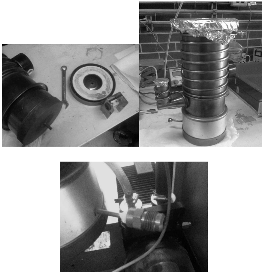
Figura 4.4. Mantenimiento a la bomba difusora.
