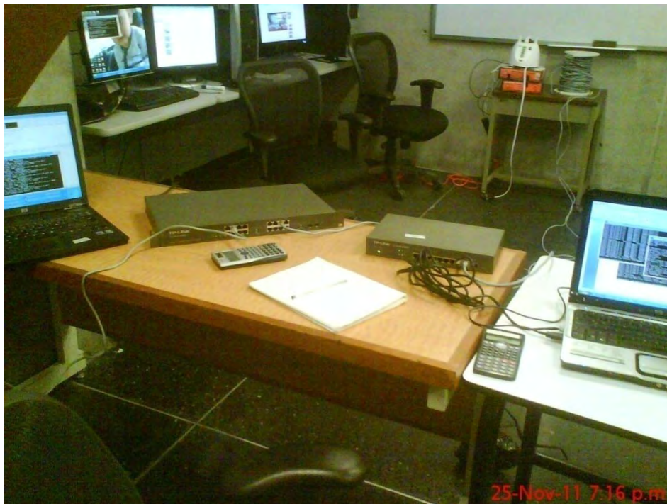
Figura 3.11. Implementación física de la red con cable UTP utilizando un cliente y un servidor
