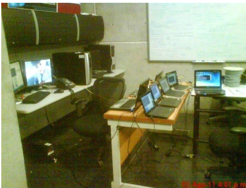
Figura 3.9. Implementación física de la red con cable UTP con 8 clientes y un servidor
