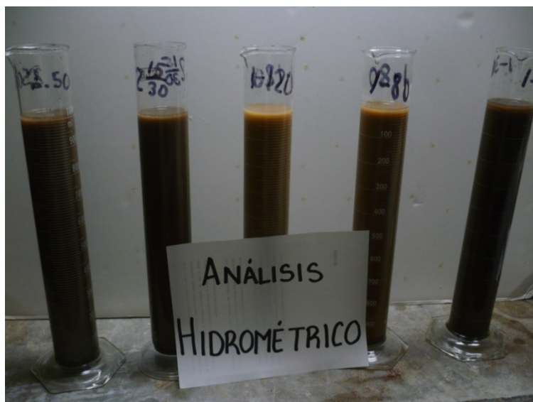
Figura 7 Mezclas del análisis hidrométrico
