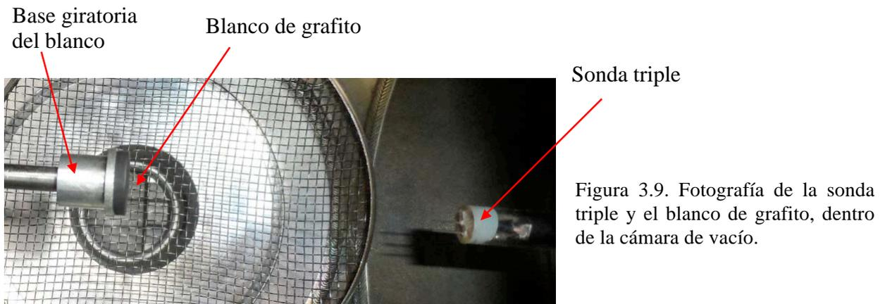
Figura 3.9. Fotografía de la sonda triple y el blanco de grafito, dentro de la cámara de vacío.
