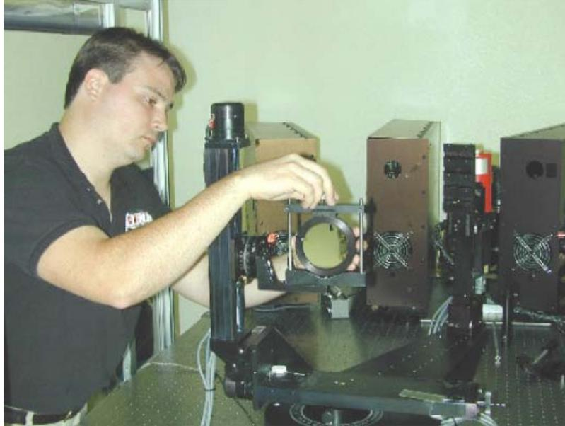
**Figura 1.5** Esparcímetero unidimensional de barrido empleado en un laboratorio.
