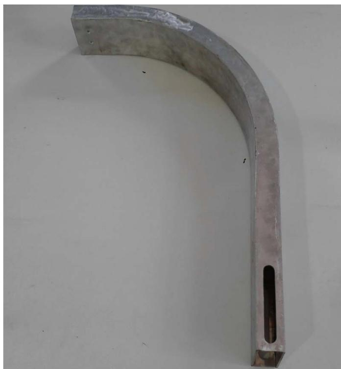
**Figura 6.2** Brazo  $B_1$  del esparcómetro obtenido después de un proceso de soldadura.
