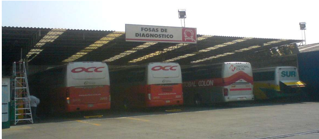
Figura 4.- Área de Fosas de Diagnostico, (REVISIÓN DE PUNTOS DE SEGURIDAD); en este lugar se realiza la revisión mecánica y eléctrica de todos autobuses y de todas las Marcas Comerciales.
