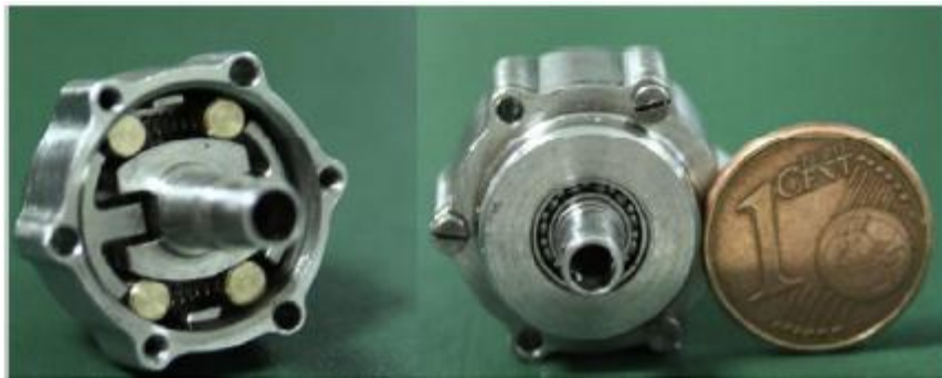
Fig. 4.18 Mecanismo de bloqueo de la Smart Hand [57]
