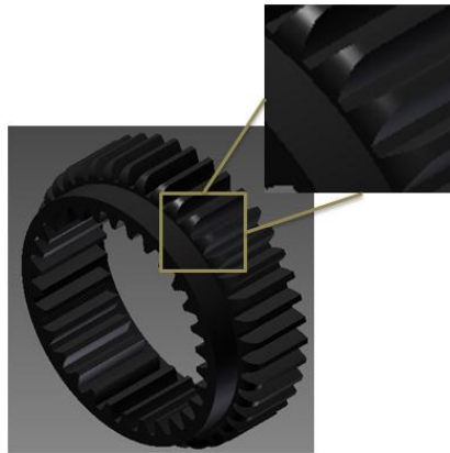
Fig. 5.16 Redondeo de los dientes externos del engrane móvil
