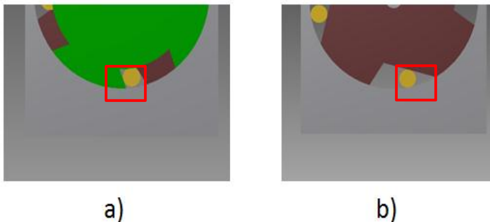
Fig. 4.22 Operación del clutch de cilindros. a) Conducción b) Bloqueo
