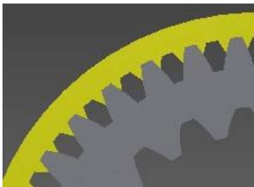
Fig. 5.8 Juego mecánico entre el engrane móvil y el anular
