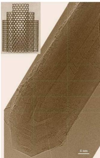
**Figura 1.6.** Nanotubo de carbono multipared del tipo c-MWNT. Monthioux *et al.*[12].
