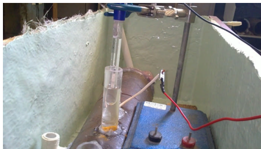
Fig. 2.10 Vista de la disposición de elementos para la realización de la prueba de ruido electroquímico.
