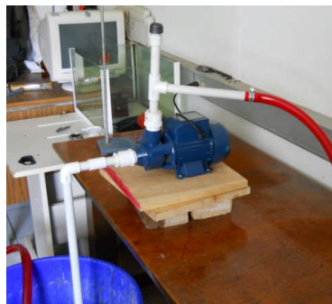
Fig. 2.8 Conexión en la entrada y salida de la bomba.
