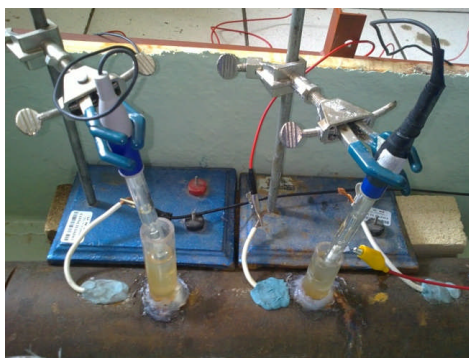
Fig. 2.11 Disposición de los elementos para realizar la prueba de resistencia a la polarización.
