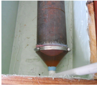
Fig. 2.6 Vista de un extremo del tubo que muestra la colocación final de los embudos.
