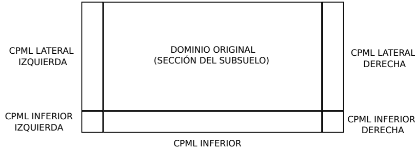
Figura 3.4: Distribución de las capas CPML laterales e inferiores en nuestro problema bidimensional.
